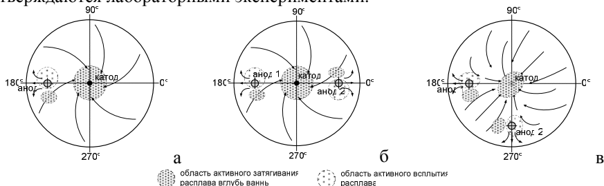
Рис 7. Схемы течения расплава на поверхности ванны: а – асимметрично расположенный анод, б – аноды расположены под углом \Delta\varphi = 180^\circ , в – аноды расположены под углом \Delta\varphi = 90^\circ
