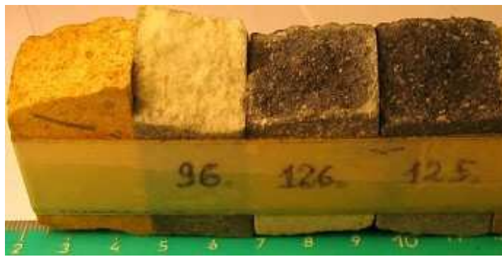
Рис. 20. Образцы периклаза (справа), газоплотненные пиролитическим графитом
