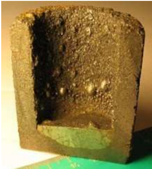
Рис. 4. Слиток и глобулы железа, полученного при восстановлении FeO
