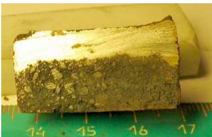
Рис. 8. Железорудный суперконцентрат после прямого восстановления, которое интенсивнее протекает в верхней части куполообразного устройства
