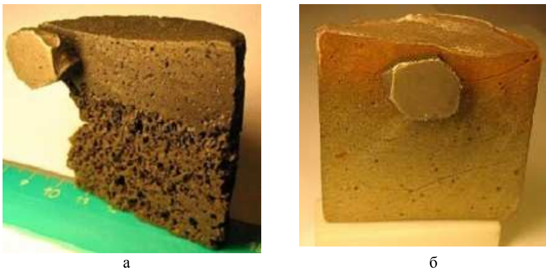
Рис. 10. Сегрегация железа от нерудных оксидов при восстановлении железной руды (а) и хвостов обогащения (б). На верхней части каждого образца удерживается магнит
