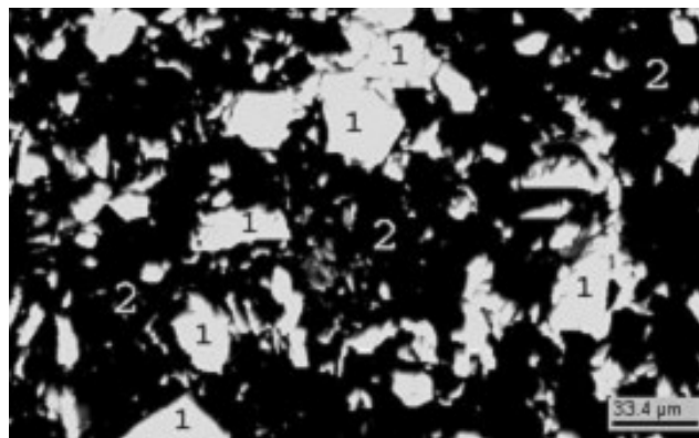
Рис. 26. Карбид циркония ZrC 0,7 , полученный при восстановлении ZrO 2 при 1280 °С (1 – ZrC 0,7 , 2 – ZrO 2 )
