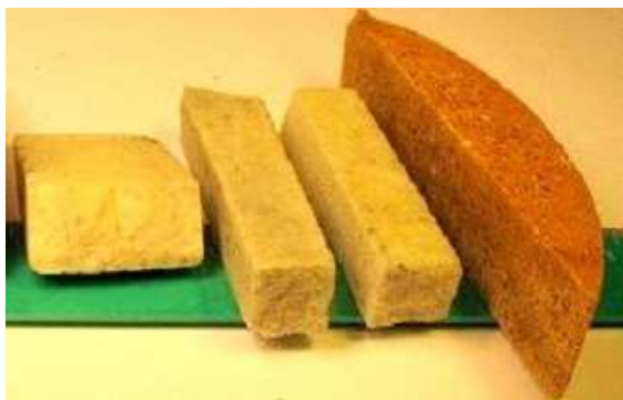
Рис. 19. Образцы периклаза (слева), очищенные от оксидов железа
