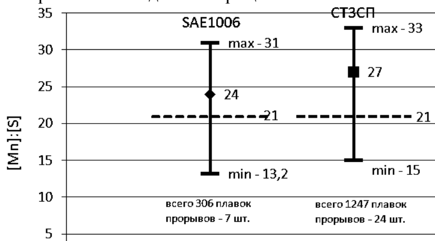
Рис. 5. Максимальные, минимальные и средние значения отношений [Mn]:[S] для стали SAE1006 и Ст3сп, разлитых на МНЛЗ ОАО «ЧМК» за 2005–2006 гг.
