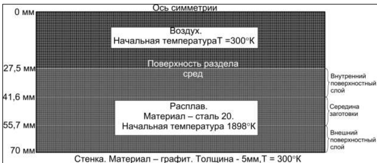
Рис. 2. Продольное сечение заготовки с задаваемыми параметрами
