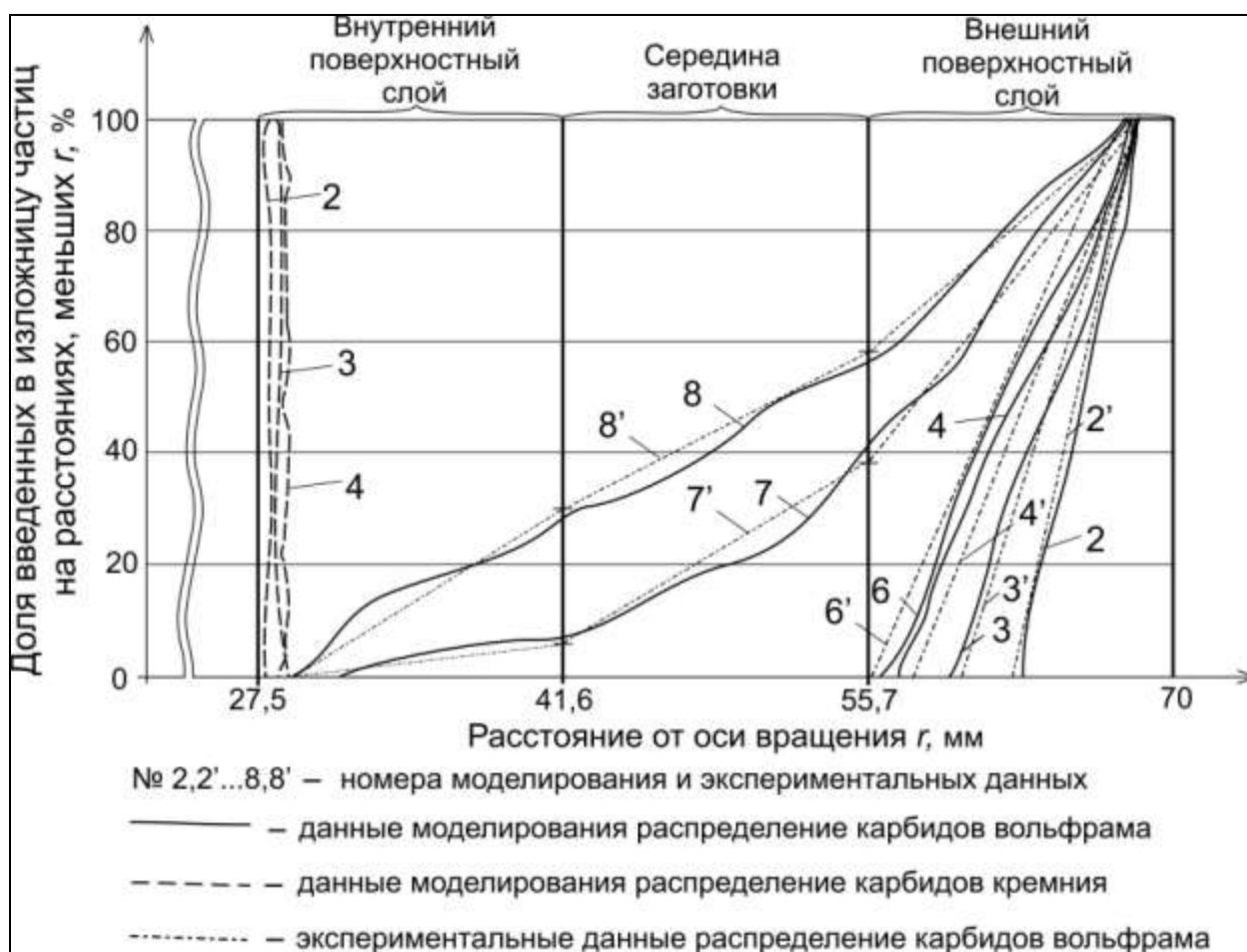
Рис. 5. Сопоставление результатов моделирования и экспериментально изученного распределения частиц
