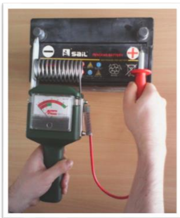
Рис. 28 Правильное расположение нагрузочной вилки
