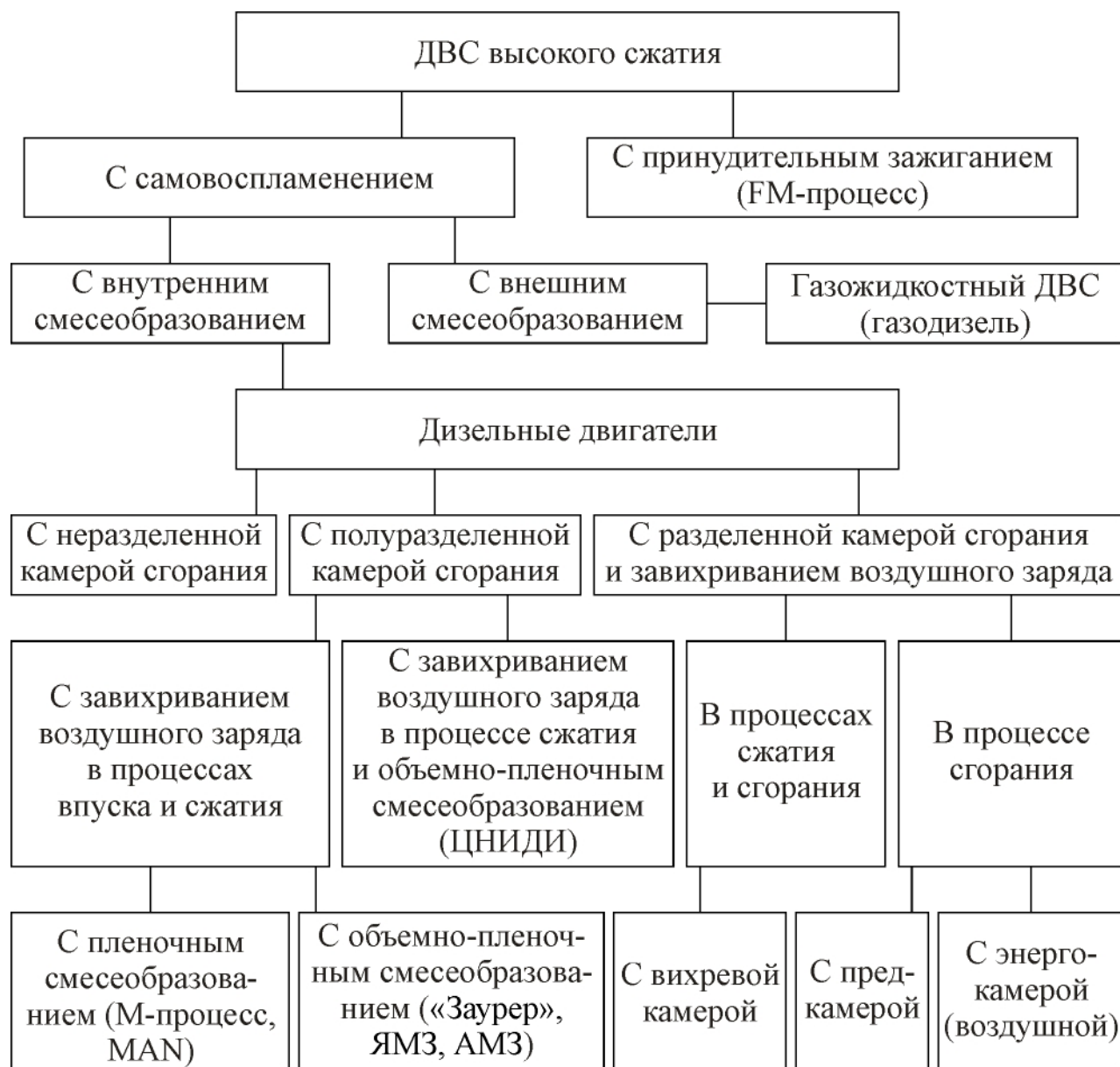
Рис. 1. 2. Схема классификации двигателей высокого сжатия
